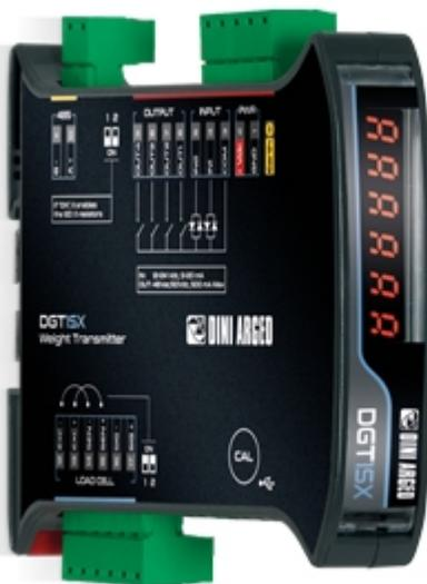
Spezifischer Wägetransmitter, ideal für dynamische und/oder robotergestützte High-Speed-Wiegesysteme. Dank seines Algorithmus und seiner hohen Umwandlungsgeschwindigkeit berechnet der Wägetransmitter das Gewicht eines Pakets auf einem Wiegeband und legt die Daten in einem Speicher ab, der über Feldbus ausgelesen werden können. Ausgelegt für einen Durchsatz von mehr als 200 Paketen pro Minute.
